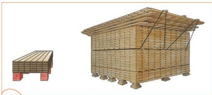
Рис. 13 Сушка пиломатериалов в штабелях
