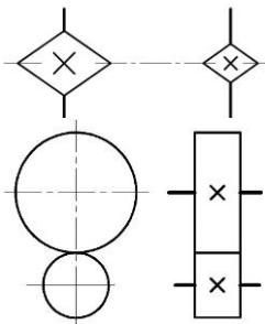
Цилиндрическая фрикционная передача
